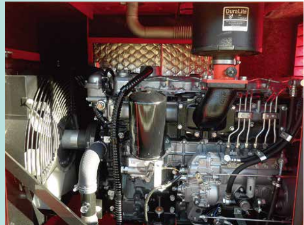
エンジン内部（排ガス完備）
